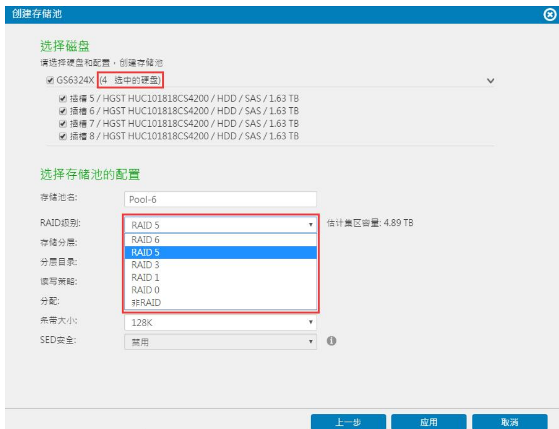
图 3-115. 存储装置-非对称双活存储池配置
