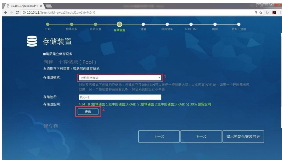
图 3-175.初始化向导-逻辑卷/存储池创建
